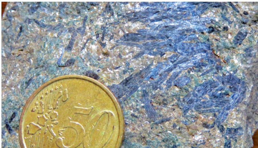
Fig. 4.04 - Glaucofaniti a pirosseno Na, mica bianca e granato, presso il pilone 14 della cabinovia Plan Maison - Cime Bianche Laghi (Unità Zermatt-Saas; Valtournenche).
