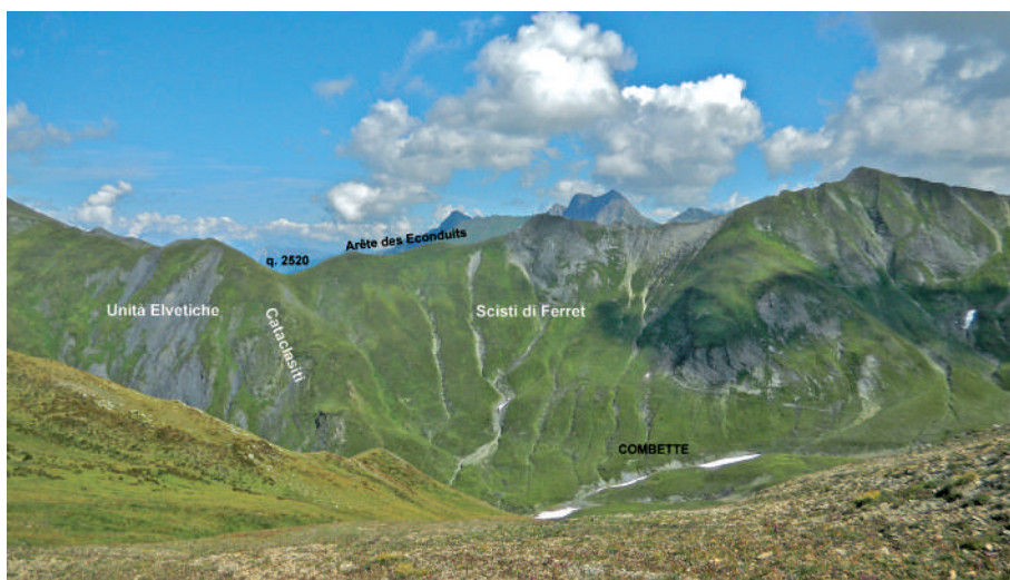
Fig. 1.14 - Contatto tra gli Scisti di Ferret e le Elvetidi, marcato da una fascia cataclastica con scaglie di dolomia e di marmi, sul versante destro idr. de la Combette (Val Ferret).
